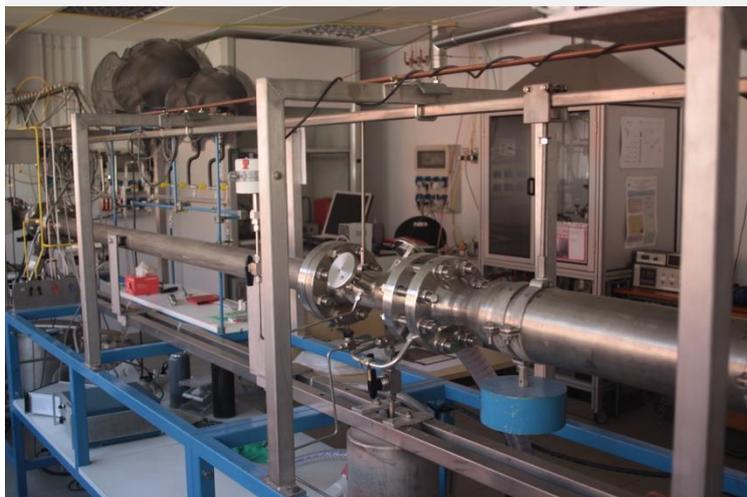
Légende : Tubes en or chargé en hydrocarbures, fermés et placés dans une autoclave. Domaine expérimental : 300 – 500°C 1h – plusieurs jours 1 bar – 700 bar
